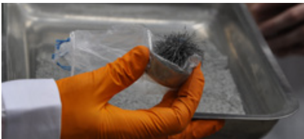
Fibres métalliques de béton fibré obtenues après l'utilisation de l'équipement Selfrag. La libération sélective de ces fibres permettra de les réutiliser dans la formulation de nouveaux bétons fibrés.
