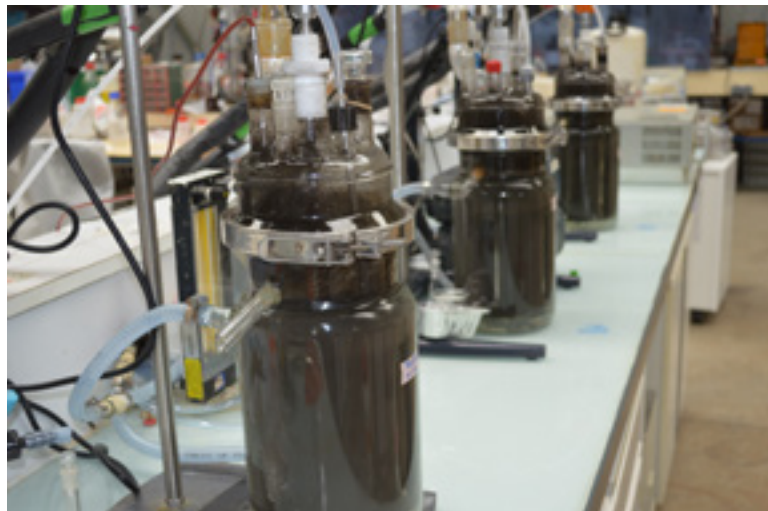
Banc de réacteurs batch pour l'étude des phénomènes physico-chimiques intervenant dans la biolixiviation. © BRGM - Y. MÉNARD
