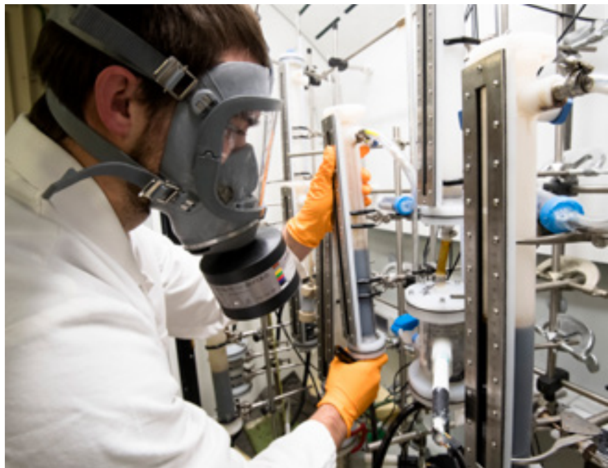
Plateforme submétrique PRIME permettant d'étudier les interactions entre phases de polluants purs et sols. © BRGM - D. DEPOORTER
