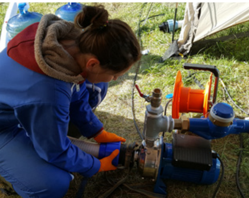
Opération de pompage d'essai sur site de recharge.
