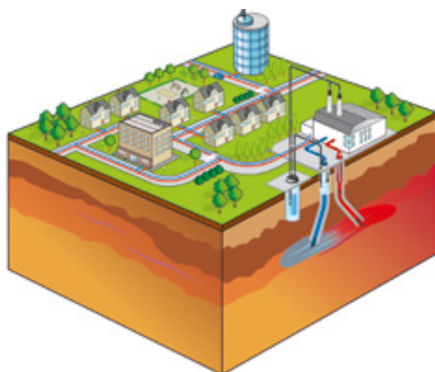
Concept d'une installation de stockage de CO 2 par dissolution en aquifère salin, couplée à la production de chaleur géothermique. © BRGM
