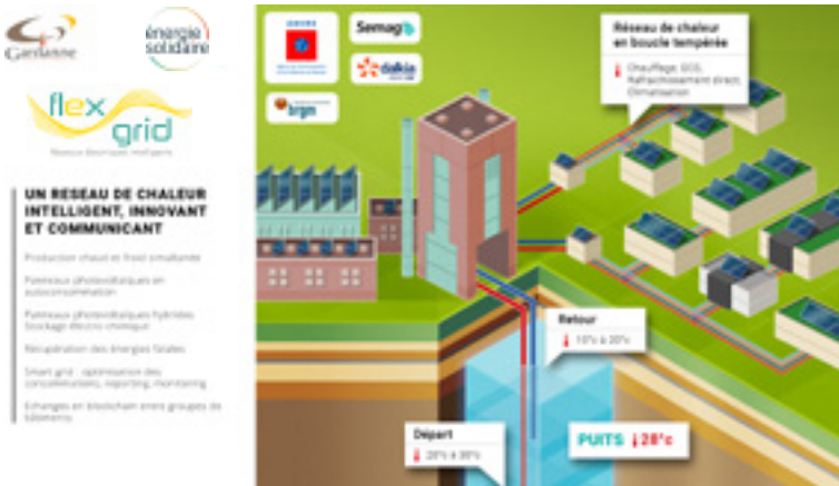
Réseau de chaleur géothermique du Puit Yvon Morandat. © Semag
