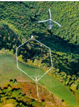
Campagne d'acquisition aéroportée de données géophysiques sur le Massif central. La même technique est employée sur les cinq chantiers territoriaux de l'actualisation de l'Inventaire national des ressources minérales, confiée au BRGM. © ALEXANDRE MAGNAN
