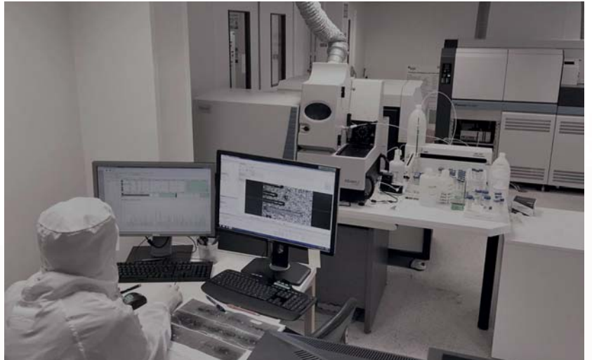
Mesures élémentaires par couplage laser ICP-MS et isotopiques avec le MC-ICPMS NEPTUNE - laboratoires du BRGM à Orléans. © BRGM
