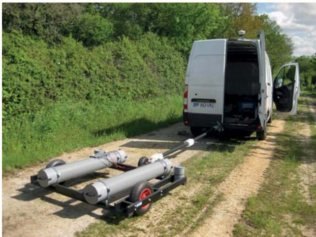
Dispositif de détection des couches de serpentinite, un matériau amiantifère. © BRGM – Jean-Christophe Gourry
