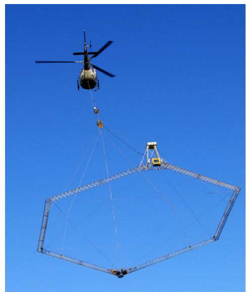
Dispositif de géophysique hélicoptérée © BRGM
