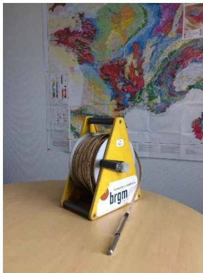
Sonde piézométrique : la partie métallique est plongée dans le puits et sonne au contact de l'eau souterraine. © BRGM
