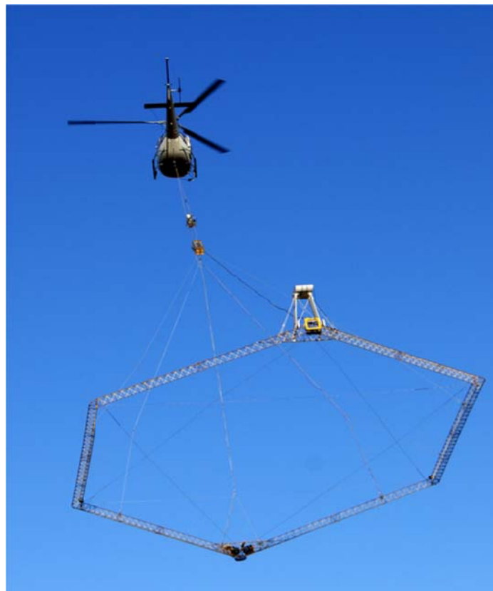
Appareillage EM et MAG tracté par l'hélicoptère à 50 m au-dessus du sol (photo J. PERRIN)
